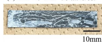
図 3 スラグを水熱処理した後の溶液に浸漬し、(a)常温常圧、(b)150°Cの水熱環境、で保持した後の Zn 板の外観。
