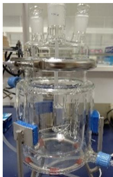
図 2 二重管式酸処理装置
