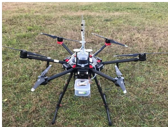
図 1 ドローン搭載型高流量捕集システム （ドローン：DJI 製，Matrice600Pro）
