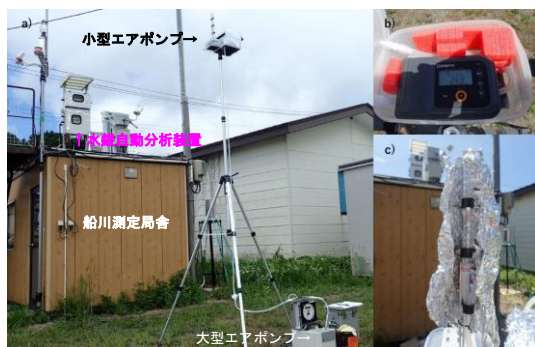
図 2 並行観測実験 a) 地上観測時の状況，b) 捕集用小型エアポンプ，c) 小型エアポンプに連結した水銀捕集管 （1 連）ホルダーとホルダー固定用マウント
