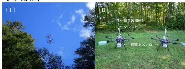
図4 2機の大型ドローンを用いた同時時間捕集法
