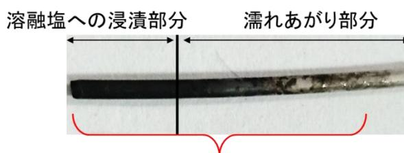
CO<sub>2</sub>還元反応により電極上に生成した固体炭素
