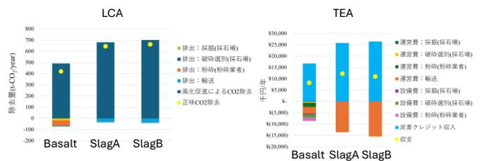
図5 精進川休廃止鉱山における玄武岩、SlagA、Bの風化促進のLCS/TEA評価結果
