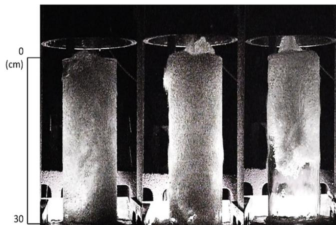
図-3 液膜の形成 (左から  $D=3,8,12\text{mm}$ )
