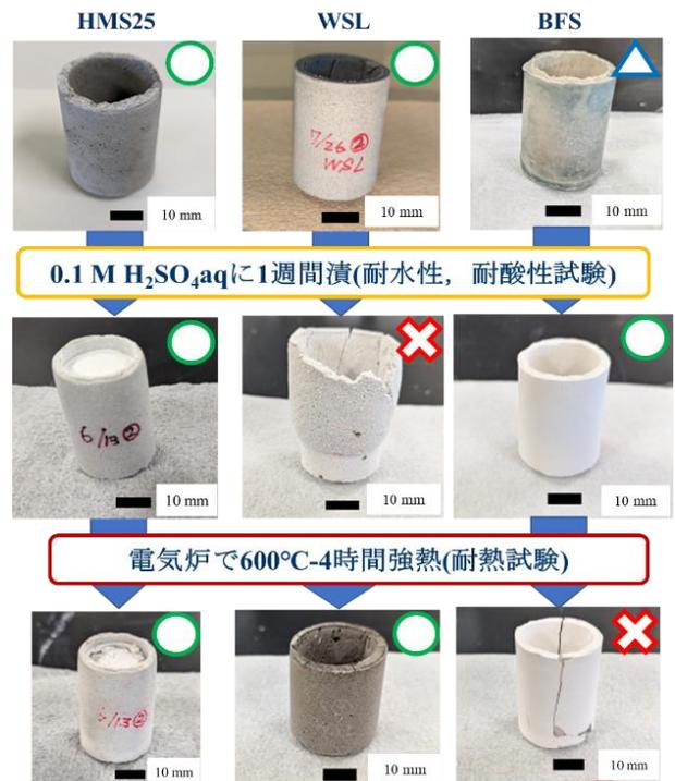
Fig.4 各試料の希硫酸浸漬後、強熱後の外観変化
