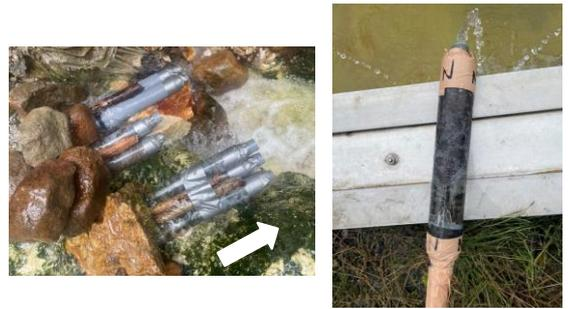
図4 現地カラム溶出試験(左:精進川休廃止鉱山、右;幌別硫黄鉱山)
