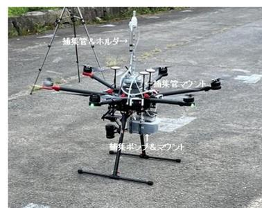
図1 ドローン搭載型GEM捕集システム
